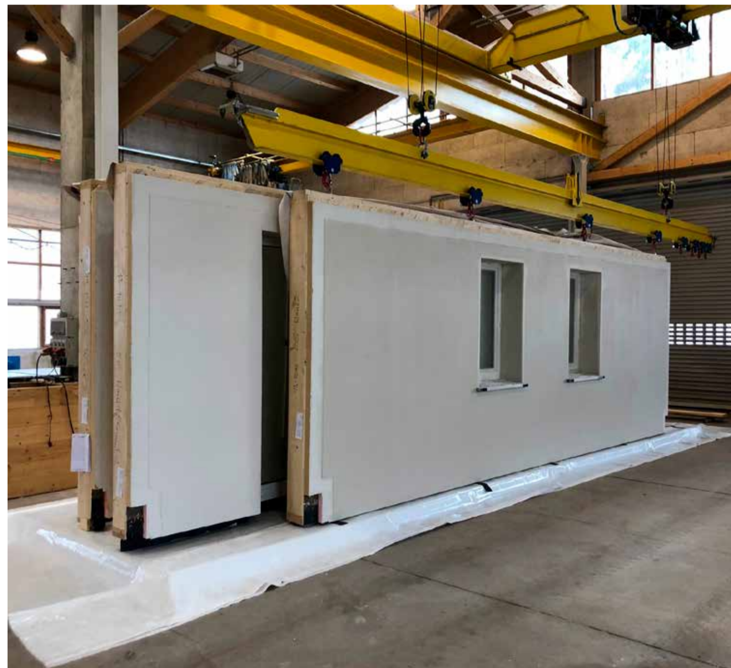
Vorgefertigte Wandelemente bei der Verladung auf die Wechselbrücken
